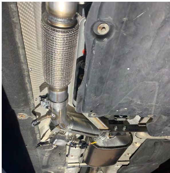
Nachgerüstetes Katalysatormodul im Unterflurbereich
